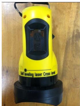
a) Máy lấy điểm góc vuông laser
