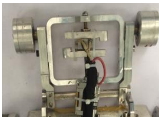
Hình 5.9: Cơ cấu mang đầu đo [27]
