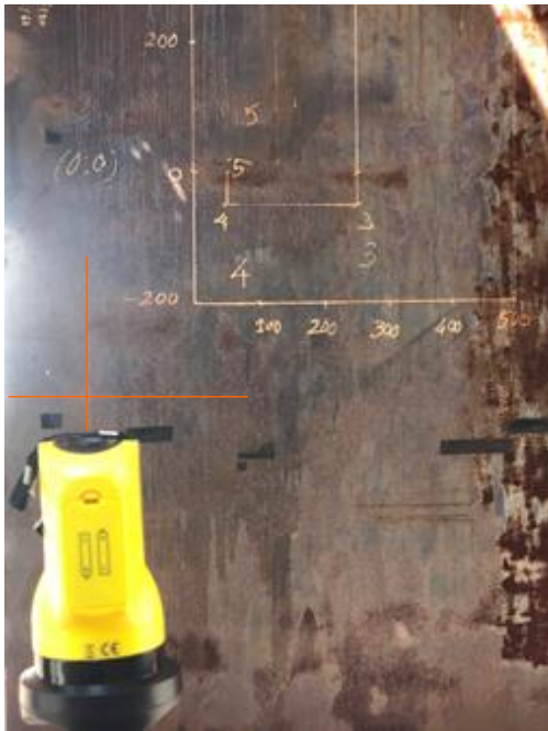
a) Định vị thước chuẩn bằng Laser
